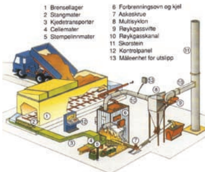
Hovedkomponentene i et biobrenselanlegg (Ferrolli/Energigården)
